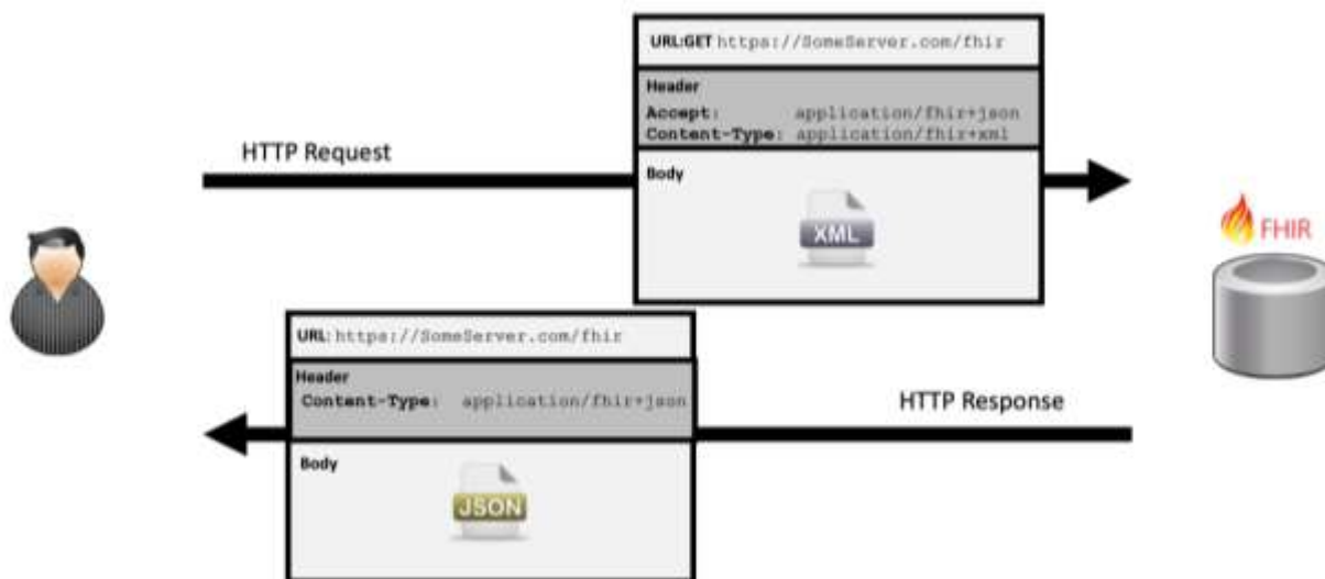
รูปที่ 22 แผนภาพแสดงกลไกการแลกเปลี่ยนข้อมูลรูปแบบ REST ในมาตรฐาน HL7 FHIR
